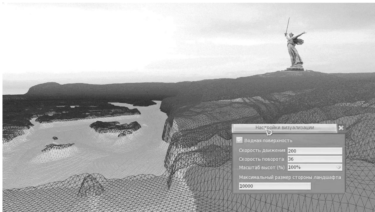
Рис. 3. Трехмерный рельеф в сеточном виде и установка параметров визуализации для панорамной съемки
